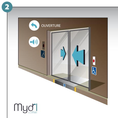
2 - Fermeture et verrouillage de la porte et mise en route du signal sonore et visuel.
